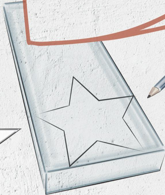
3 Mit der Säge das Motiv aus dem Porenbetonstein vorsichtig herausarbeiten. Details und Ecken lassen sich am besten mit Feilen bearbeiten.
