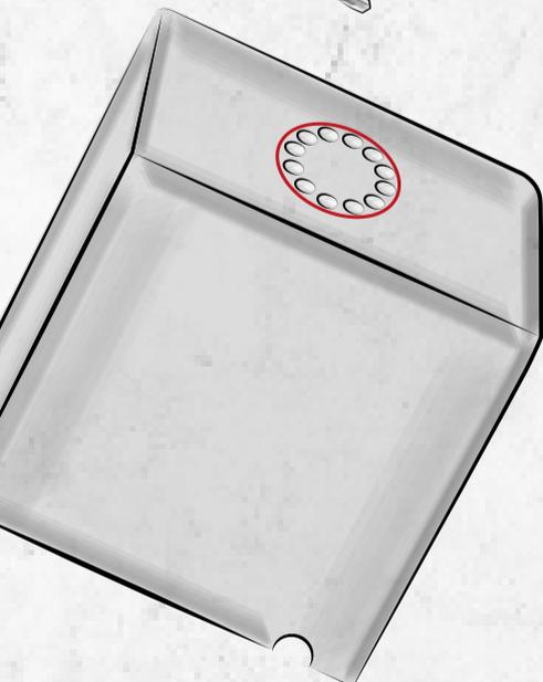
5 Löcher entlang des inneren Kreises der Markierung bohren und verbinden, um eine Aussparung im Durchmesser der Fassung zu erhalten. Am unteren Rand vorsichtig eine Aussparung für das Kabel heraus bohren.
