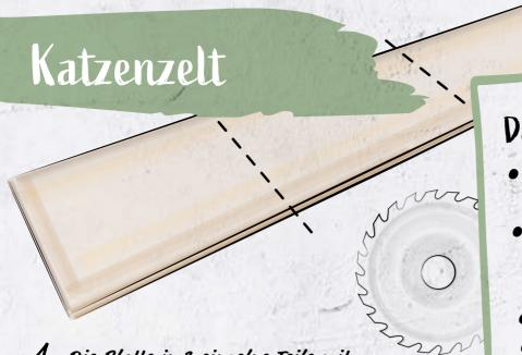
1 Die Platte in 3 einzelne Teile mit je einer Größe von 800 x 500 mm sägen. Am besten eine Handkreissäge mit Führungsschiene einsetzen. Die Schnittkauten mit dem Schleifpapier sauber glätten.
