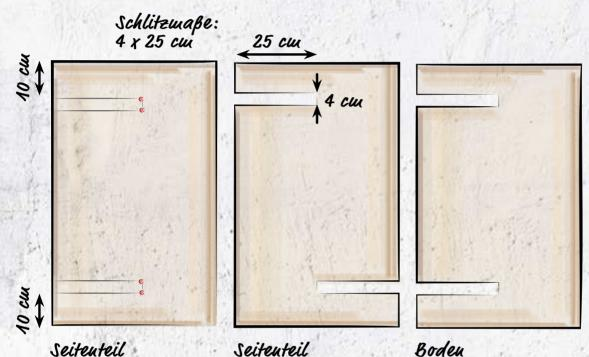
Z In die 3 Teile sollen Schlitze gesägt werden. Dabei darauf achten, dass die Schlitzbreite größer als die Brettstärke ausfällt und die Schlitzlänge der Hälfte der Brettbreite entspicht. Schlitze auzeichnen und Löcher in die Ecken oder mit einem Forstnerbohrer ein großes Loch bohren. Mit der Stichsäge die Schlitze heraussägen.
