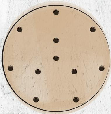
**4** Das kleine Stück Kupferrohr als Klöppel an der Schaur festbinden und zwischen den Rohrstücken positionieren. Das andere Schaurende durch das mittige Loch der Holzscheibe führen und mehrmals verknöten, bis es nicht mehr durch das Loch rutschen kann.
