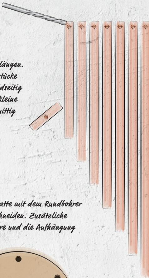
**2** Aus der Holzplatte mit dem Rundbohrer eine Scheibe ausschneiden. Zusätzliche Löcher für die Rohre und die Aufhängung bohren.
