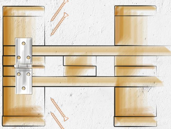
3 Beide Baudiele zuschneiden auf 2x 1.875 mm, 6x 130 mm und 1x 400 mm. Die 130-mm-Stücke bündig zur Oberseite der langen Palette auf den Klötzen befestigen.
